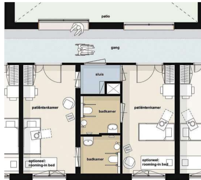
De patiëntenkamers met daartussen, grenzend aan de gang, de sluis.
